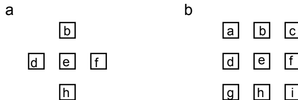
Rys. 3.88. Otoczenie w medianie pięciopunktowej (a) i dziewięciopunktowej (b).
