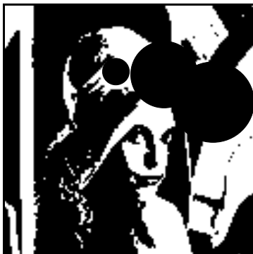
Rys. 3.77. Obraz „Lena” po zastosowaniu logicznego sumowania z obrazem trzech kółek.
