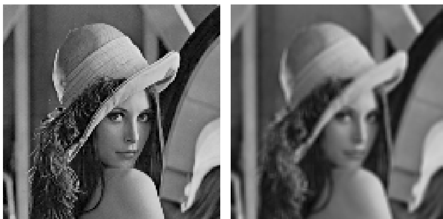
Rys. 3.43. Efekt filtracji konwolucyjnej dla niezakłóconego obrazu naturalnego.
