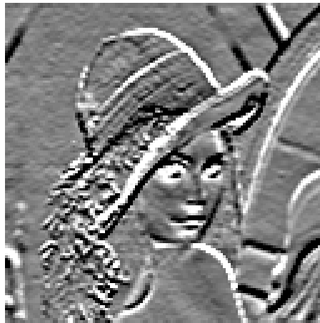
Rys. 3.54. Obraz „Lena” filtrowany górnoprzepustowo z użyciem poziomej maski Sobela.
