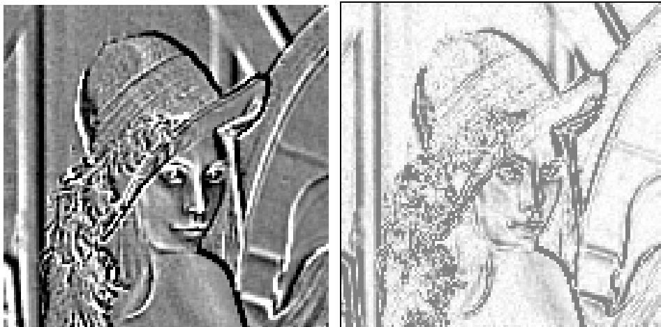
Rys. 3.59. Obraz „Lena” po wykonaniu konwolucji z maską wykrywającą narożniki. Po lewej stronie obraz wynikowy skalowany, po prawej - obraz po wykonaniu inwersji i uwzględnieniu tylko bezwzględnych wartości pikseli.
