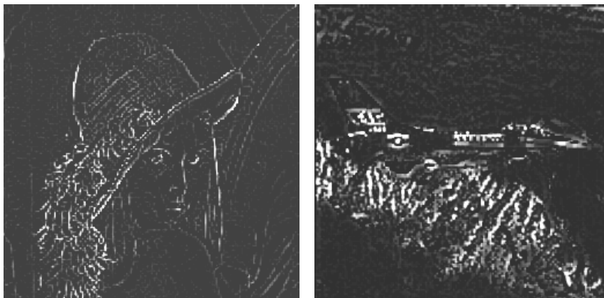
Rys. 5.17. Wynik działania operacji top-hat w wersji angażującej operację otwarcia.
