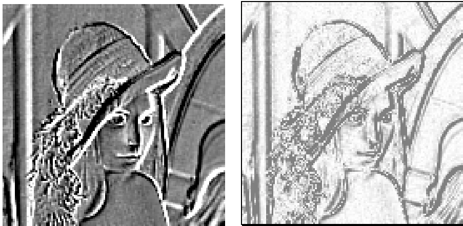
Rys. 3.60. Obraz „Lena” po wykonaniu konwolucji z obroconą maską wykrywającą narożniki. Układ jak na rysunku 3.59.
