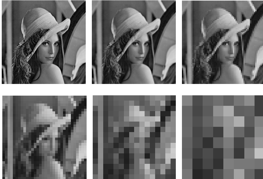
Rys. 2.7. Obraz cyfrowy „Lena” przedstawiany z coraz mniejszą rozdzielczością przestrzenną (kolejno pokazano obrazy dla M = N = 256 \times 256 , 128 \times 128 , 64 \times 64 , 32 \times 32 , 16 \times 16 i 8 \times 8 pikseli).
