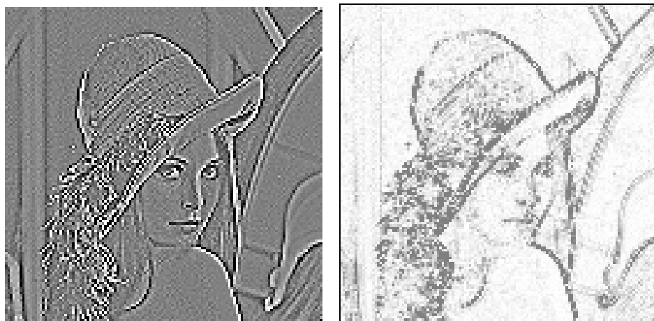
Rys. 3.62. Obraz „Lena” po zastosowaniu laplasjanu. Po lewej obraz skalowany, po prawej - moduł wartości pikseli.
