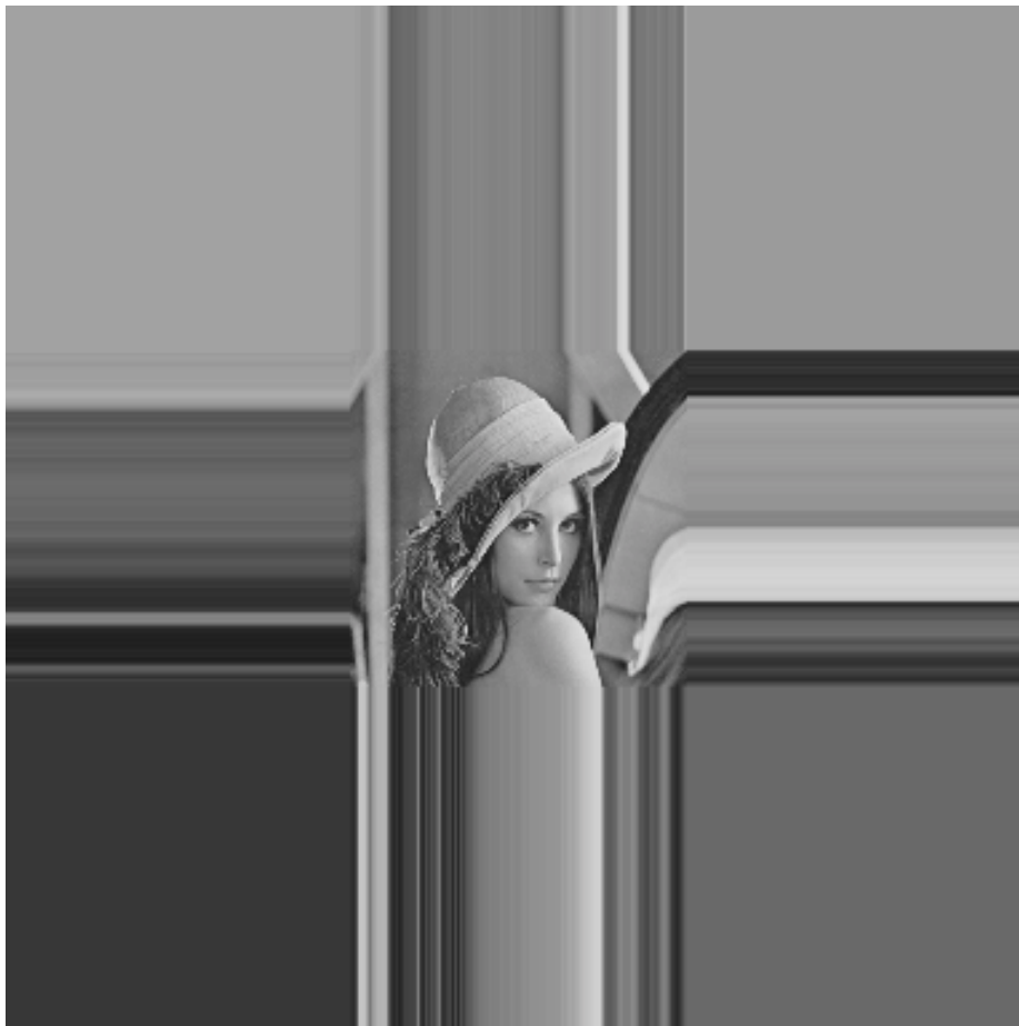
Rys. 4.65. Obraz „Lena” po powiększeniu pola obrazu za pomocą powielenia wartości pikseli z brzegu obrazu, w celu umożliwienia wyznaczenia wyniku filtracji za pomocą maski w pobliżu brzegu obrazu.
