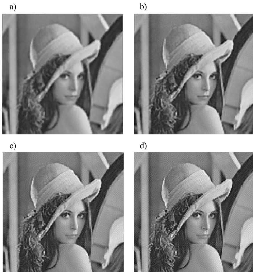
Rys. 4.82. Obraz odtworzony po kolejnych iteracjach metody rekurencyjnej według wzoru (4.57): a) po pierwszej iteracji, b) po 6 iteracjach, c) po 24 iteracjach, d) po 40 iteracjach.
